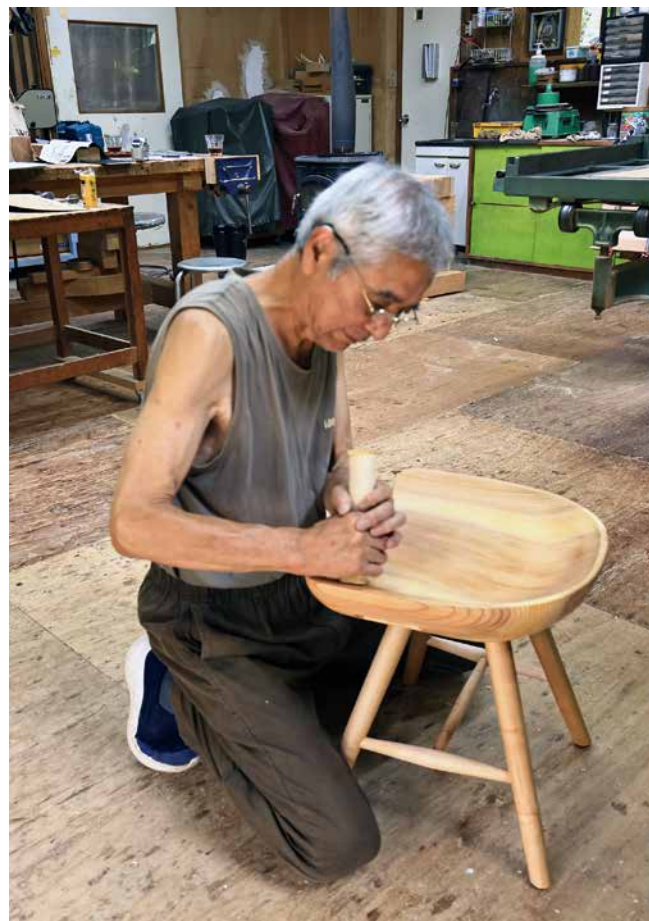
手入れの行き届いた機械や道具が整然と置かれた工房内。 製作中の椅子は座面がスギで「浮造加工」オイル仕上げ、脚は堅牢な広葉樹。
