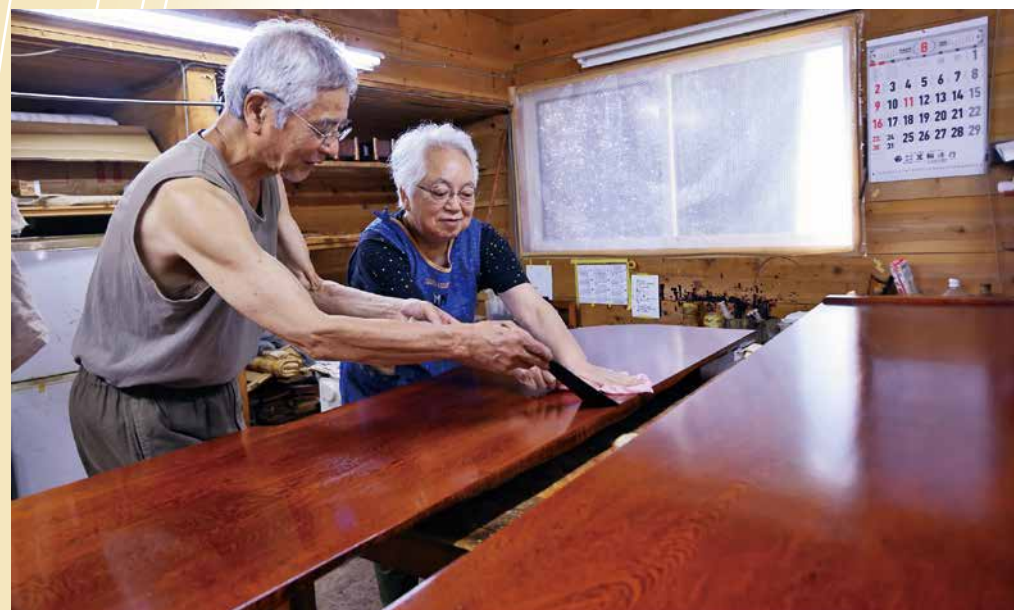
拭き漆作業は主に奥様の美保子さんが担当し、大型の物は共同作業で行う。塗装には素材の美しさが出る拭き漆や自然塗料のオイルを使用して仕上げている。
