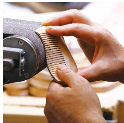
「ひねり髪すき」の製作は繊細だ。研ぎ澄まされた指先の感覚で何ミリ削れたかわかるという。
